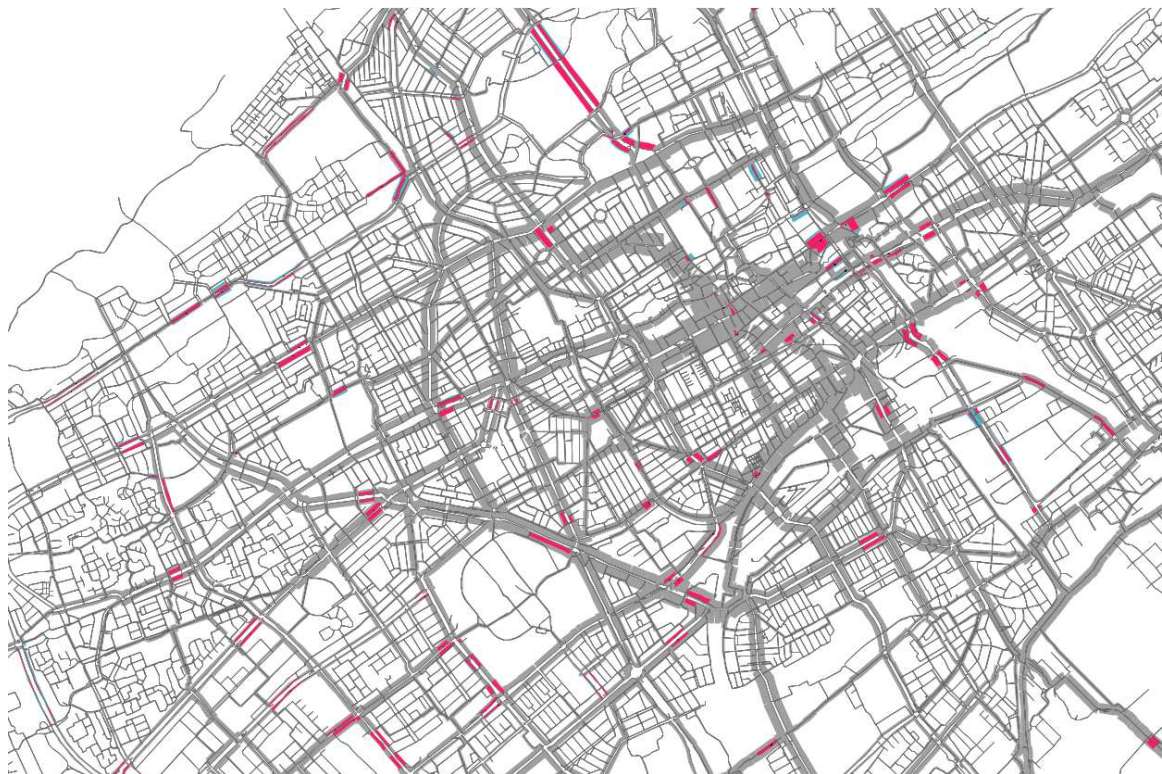
Figuur 3. Uitsnede van de fietstoedeling in Den Haag, modelwaarden (grijs) vergeleken met telwaarden (rood)
